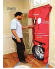
blower door test
